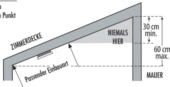
**WICHTIG:** Das vernetzte Modell **INSAFE+ Origin** muss **UNBEDINGT AN DER WAND ANGEBRACHT WERDEN**, und zwar in einem Abstand von 60 cm unter der Decke.
