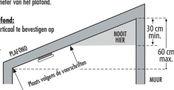
**BELANGRIJK:** Het connected model **INSAFE+ Origin** moet **VERPLICHT AAN DE WAND BEVESTIGD WORDEN**, 60 cm onder het plafond.
