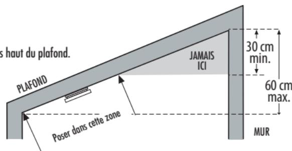
**IMPORTANT :** Le modèle connecté **INSAFE+ Origin** doit être **IMPÉRATIVEMENT FIXÉ AU MUR** à une distance de 60 cm sous le plafond.
